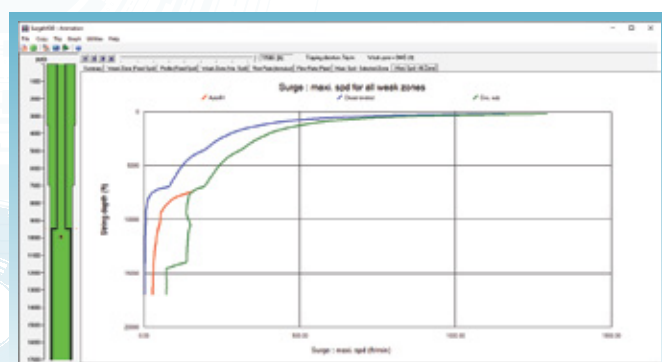
管柱运行到不同深度，确保所有弱地层安全时的最大下放速
